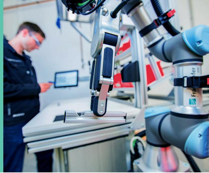
3 *Anpassung an neue Anwendungsszenarien ohne aufwendige Umbau- und Rüstarbeiten | Adapting to new application scenarios without time-consuming conversion and retooling work* 4 *Der Assistenzroboter erkennt eigenständig Bauteile auf einem Montagearbeitsplatz | The assistance robot autonomously identifies components at an assembly workstation*
