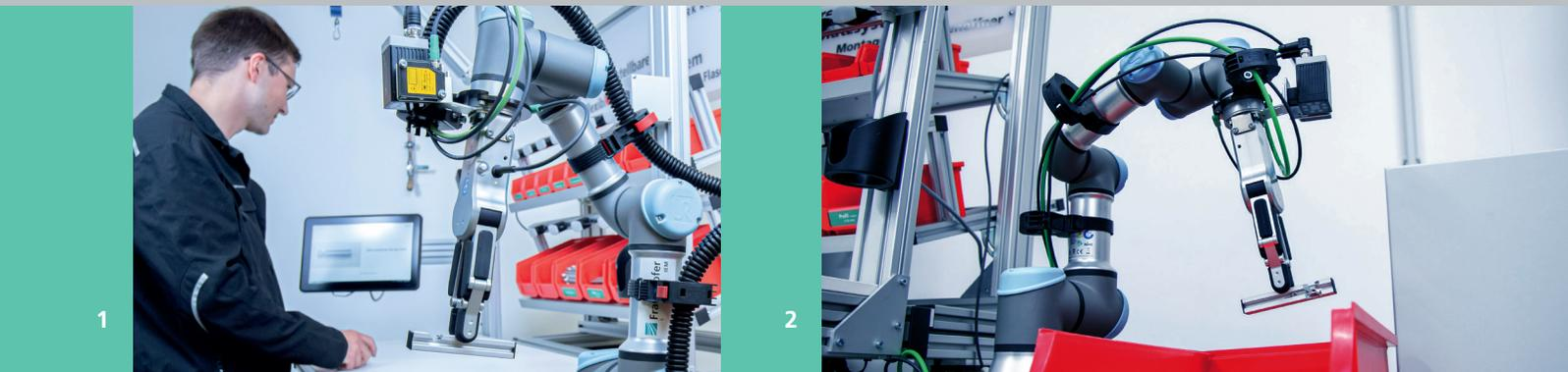
**1** Bei der Baugruppenmontage unterstützt der kollaborative Roboter (Cobot) den Mitarbeiter beim Abtransport der Bauteile |
