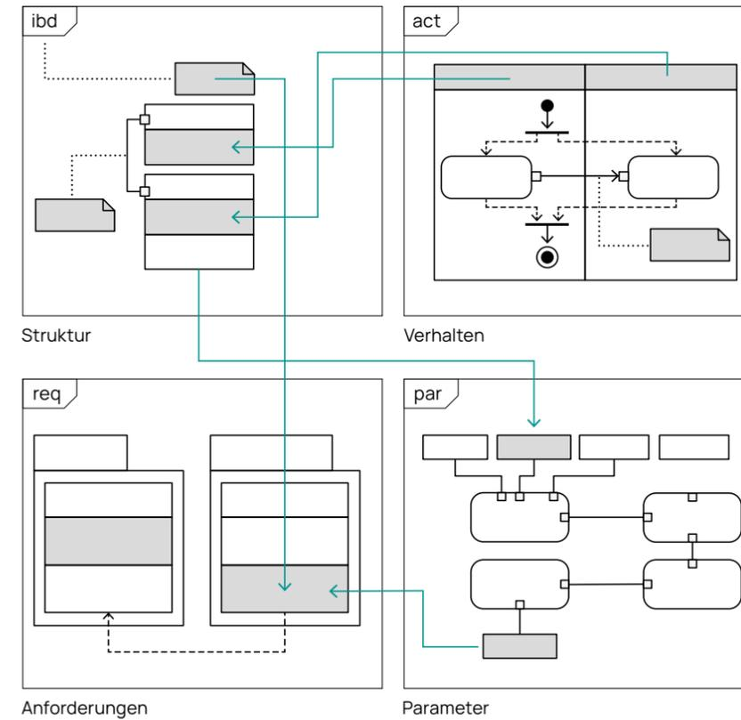
Bild 12: Die vier Aspekte der SysML nach [FMS14]
